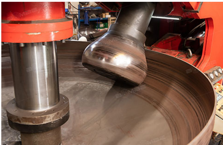
Рисунок 14 - Накатка малого радиуса днища на машине SBFM 5000
