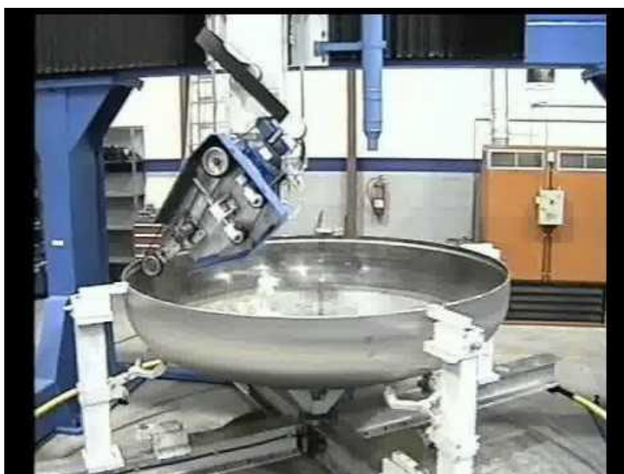
Рисунок 16 - Фаскосъемная машина FCRM 4900
