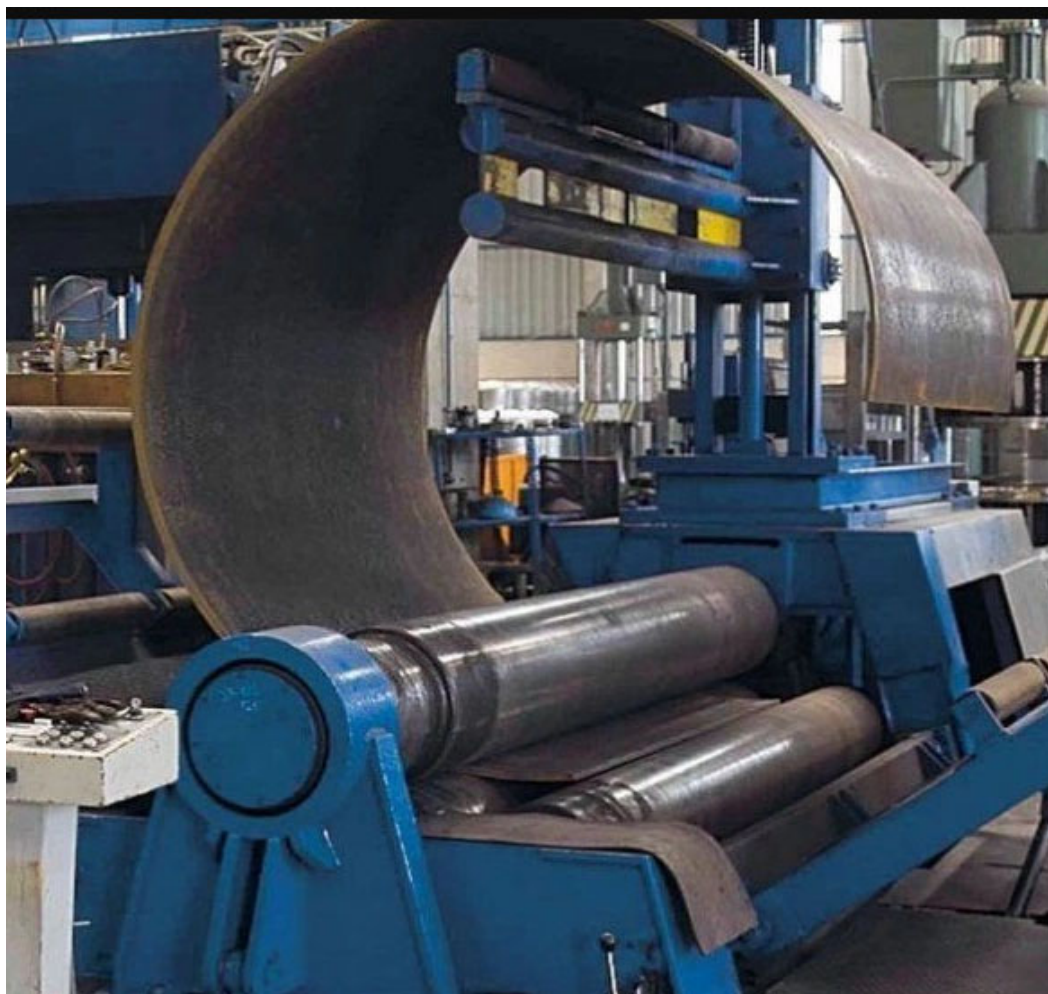
Рисунок 10 - Трех-валковые вальцы ЗНЕЛ и вальцовка обечайки
