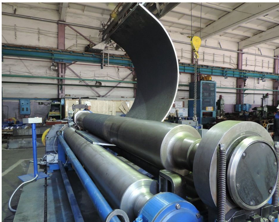
Рисунок 9 - Трех-валковые вальцы ИБ2216 и вальцовка обечайки
