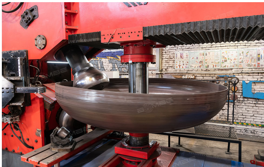
Рисунок 13 - Накатка малого радиуса днища на машине SBFM 5000
