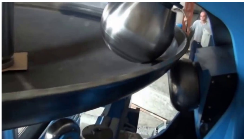
Рисунок 15- Накатка малого радиуса днища на машине SBFM 5000
